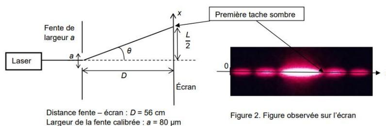
Figure 1. Schéma de l'expérience (échelle non respectée)
